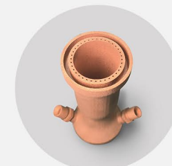
燃烧室 打印材料: 铜铬锆 流道1mm*1.35mm
