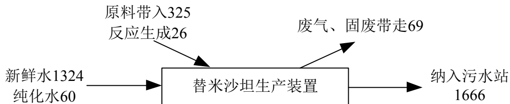
图 4.5-5 替米沙坦生产水平衡图 (t/a)
