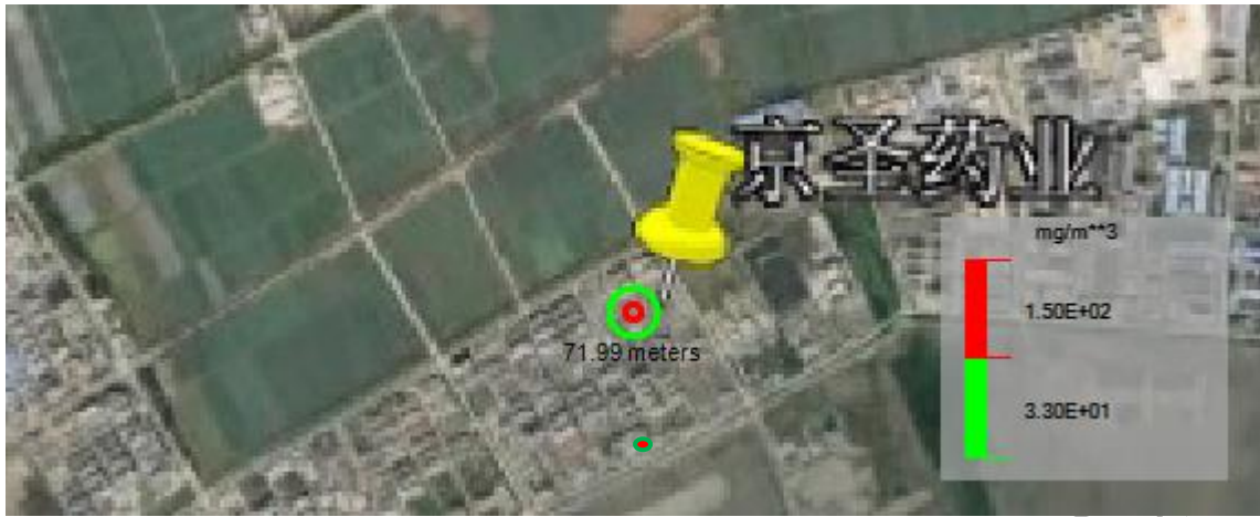
图 6.3.5-5 盐酸储罐泄漏影响预测图（最不利气象条件）
