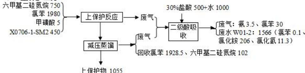
注：上保护工序流程图中批对批投料。实际生产中，每批投料减半。
