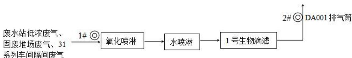
图 7.2-1 废水站、固废堆场、31 系列隔间等低浓废气处理流程及监测点位图
