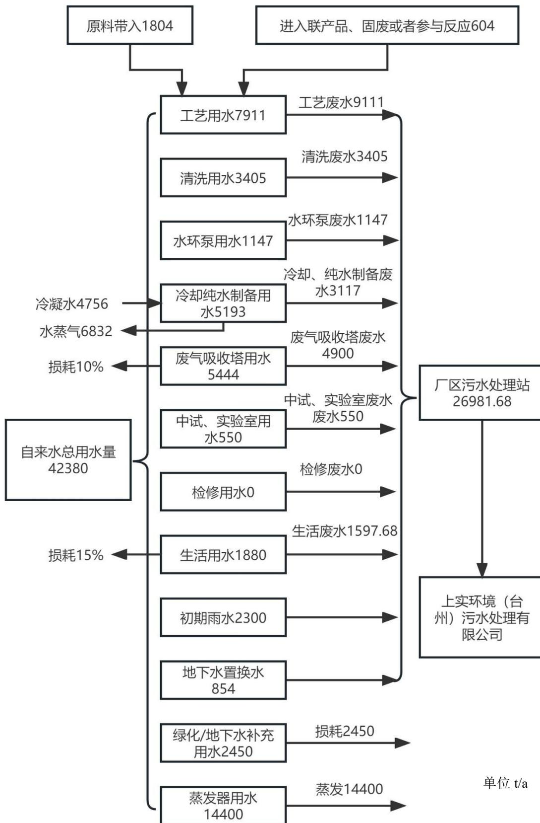
图 3.5-1 调试期间全厂项目水平衡图
