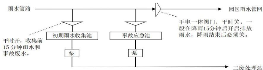
图 4.6-1 厂区事故废水及初期雨水收集系统示意图
