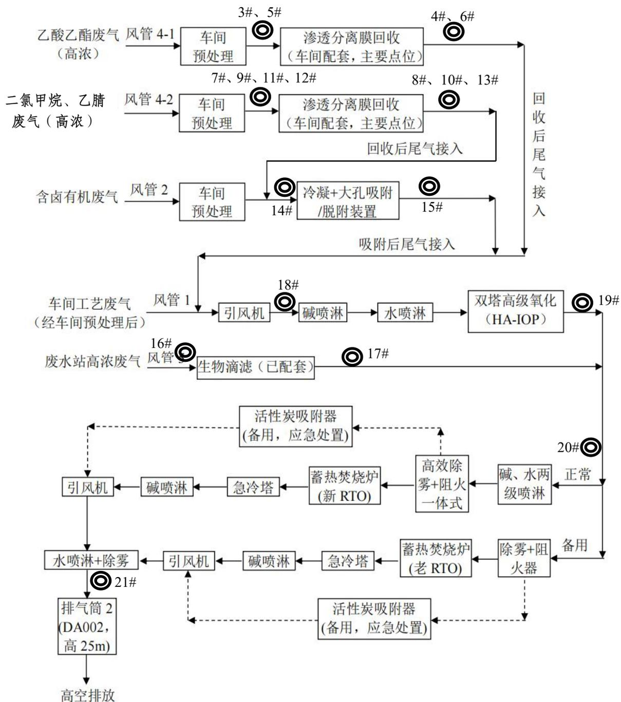
图 7.2-2 工艺废气处理流程及监测点位图
