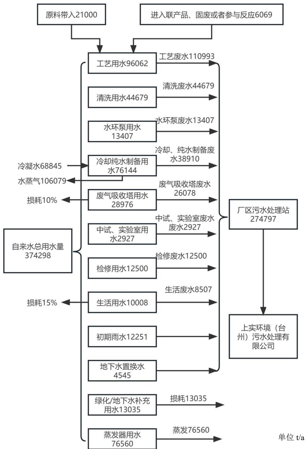
图 3.5-3 达产全厂项目水平衡图
