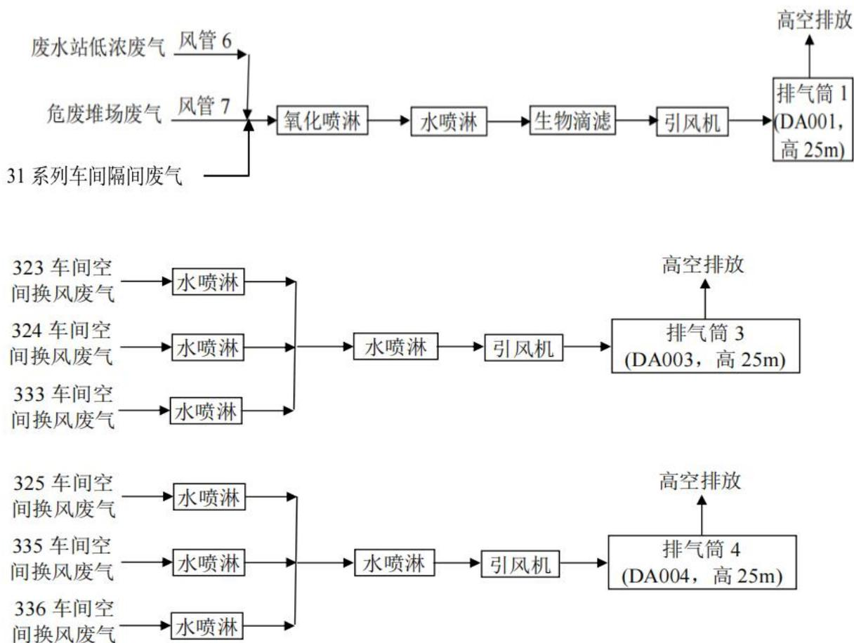
图 4.2-1 废气处理工艺流程图
