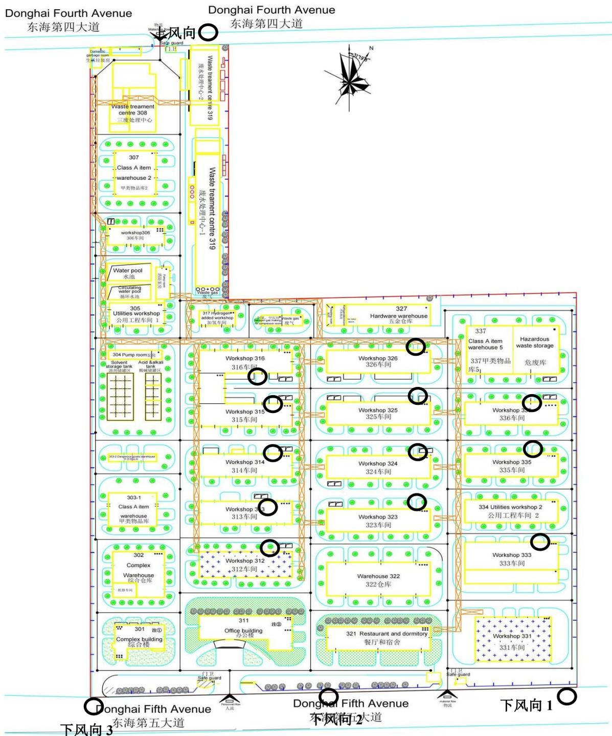
图 7.2-4 无组织废气监测点位图
