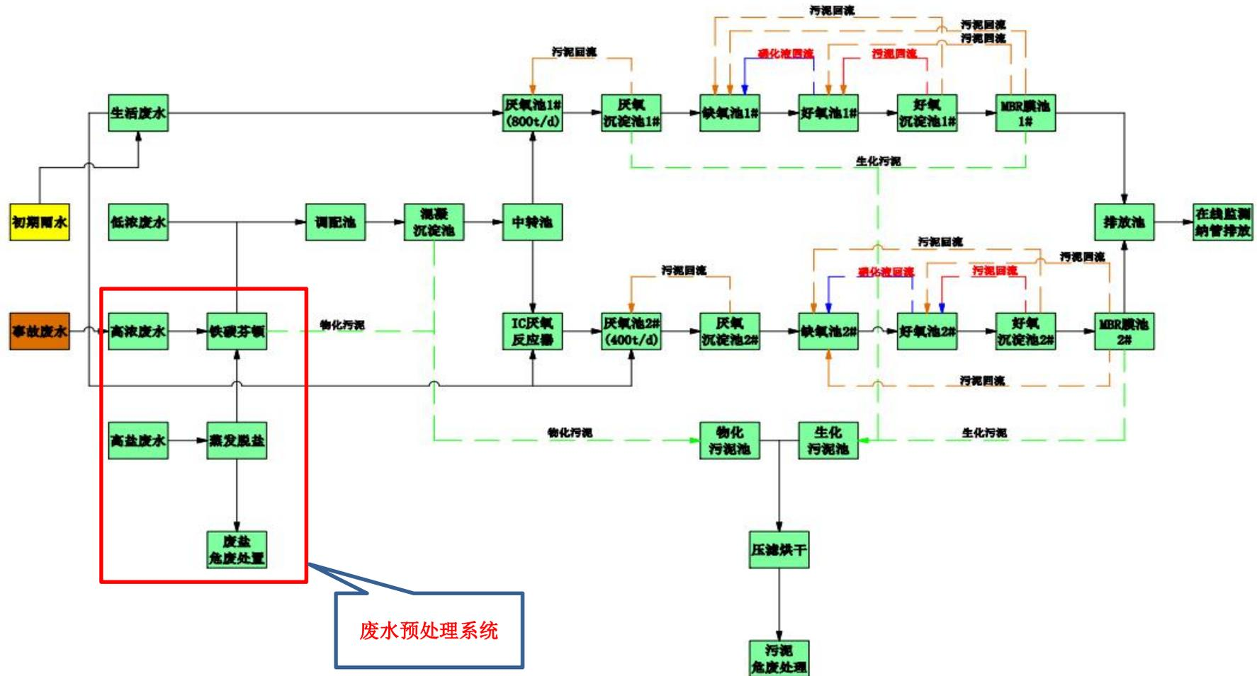
图 4.1-1 废水处理站工艺流程图
