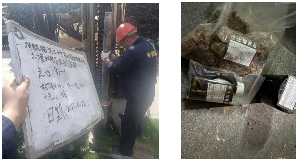
图7-1 现场土孔钻探、采集土壤样品照片
